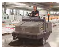
Robusto chassis in acciaio con 3 ruote
