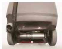
3 ruote motrici per rampe fino a 15°
