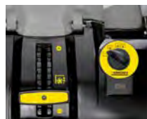
Easy Operator: selettore per selezionare il corretto programma di lavoro
