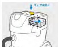
Sistema semi automatico di pulizia del filtro
