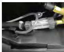
Filtro acqua. Protegge la macchina dalle impurità presenti nell'acqua
